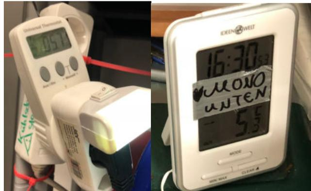
**Rechts: Sonden-thermometer (Rossmann) mit Min.-Max.-Funktion und Frostalarm**
